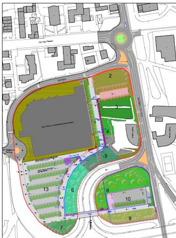
ZONE E MONTANTI IMPIANTO DI IRRIGAZIONE
